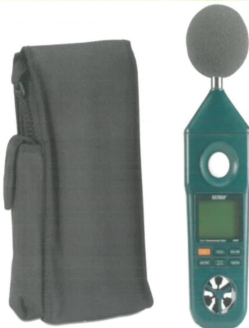
Fig. 6-2 Aparatul multiparametru Exttech 5 în 1, Environmental Meter EN 300 utilizat
