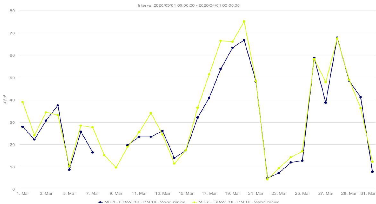
Evoluția valorilor medii zilnice ale indicatorului pulberi în suspensie, PM 10 gravimetric, la stațiile de monitorizare MS-1 și MS-2 din județul Mureș
