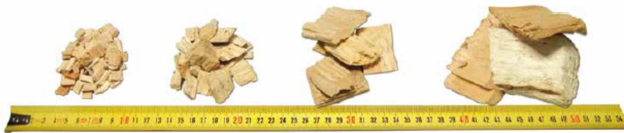
Figura nr. 9 Exemplul dimensional al tocaturii obtinute in urma operarii toculatorului mobil pe platforma Kastamonu
