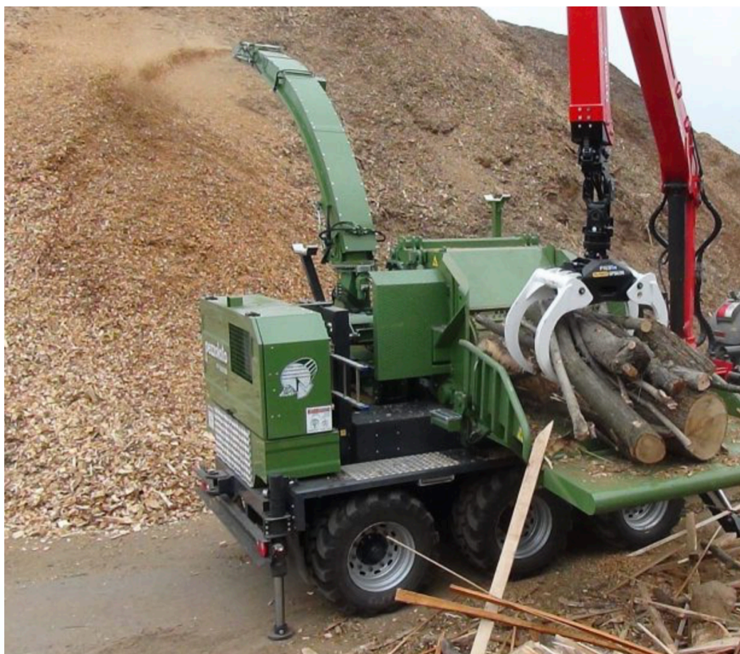
Figura nr. 8 Exemplu de functionare a Tocatorului Mobil Pezzaloto PTH 1200/1000
