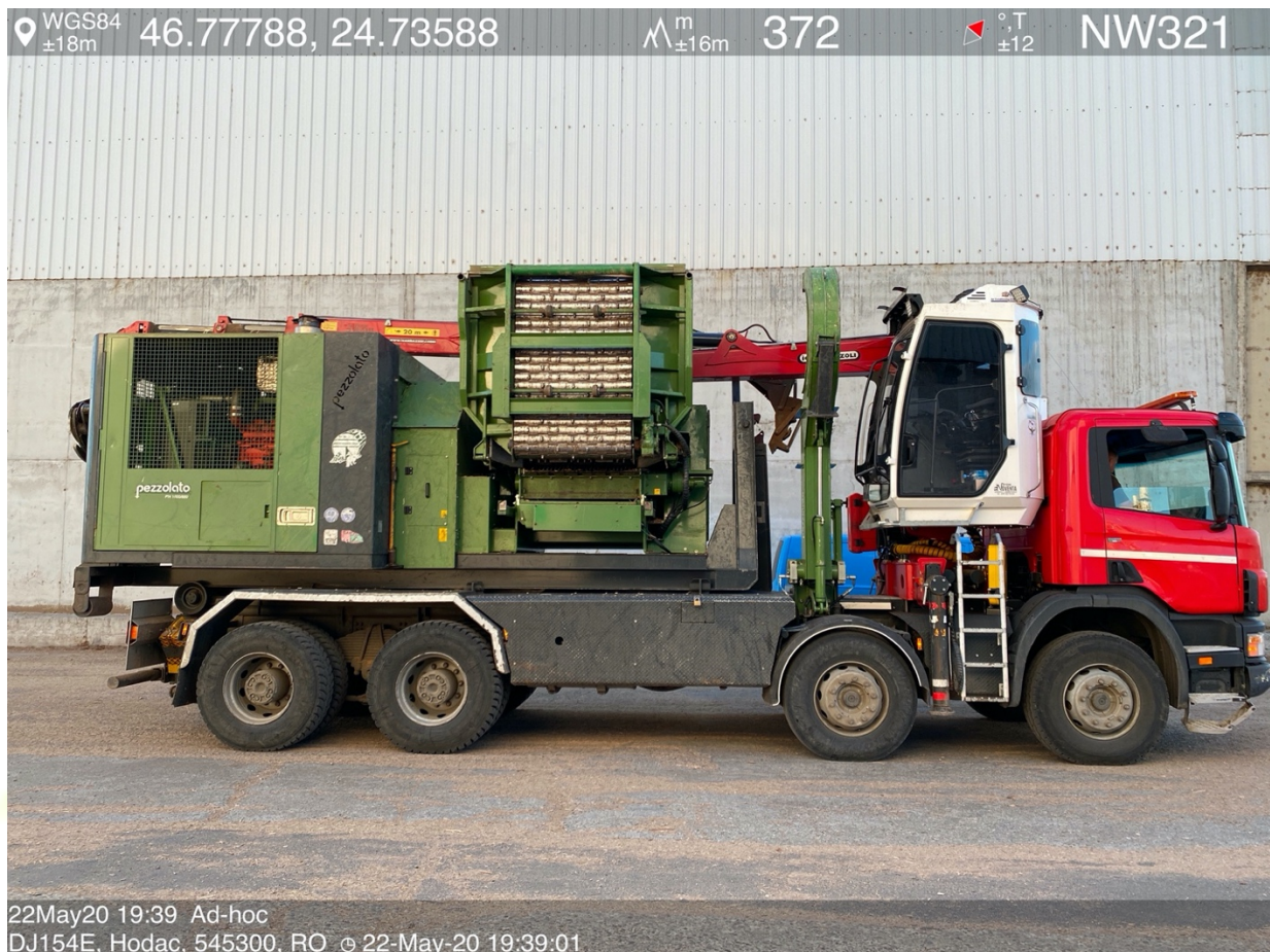
Figura nr. 10 Exemplul unui toculator mobil, adus in amplasament pentru a testa calitatea functionarii
