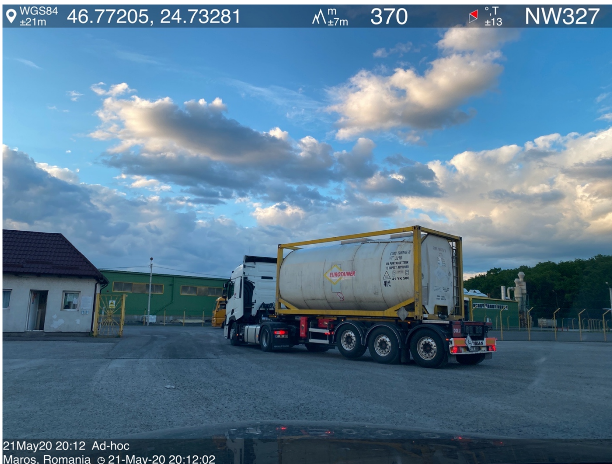
Figura nr. 56 Detaliu, cisterna transport clei pentru consum Fabrica DoorSkin, cadru de siguranta si bazin dublu etansat
