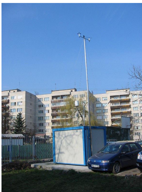
Figura I.1.2. Stația de monitorizare a fondului urban MS-1
