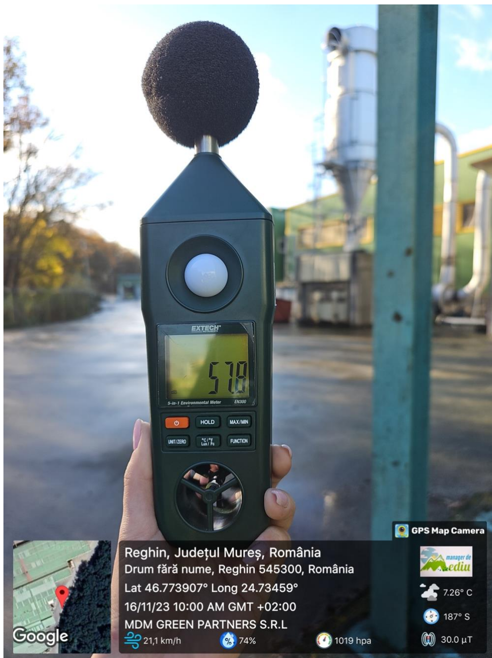
Figura nr. 6-1 Exemplul unei masuratori instantanee de zgomot, efectuata de catre inginerul expert de mediu, in perimetrul fabricii Kastamonu Romania
