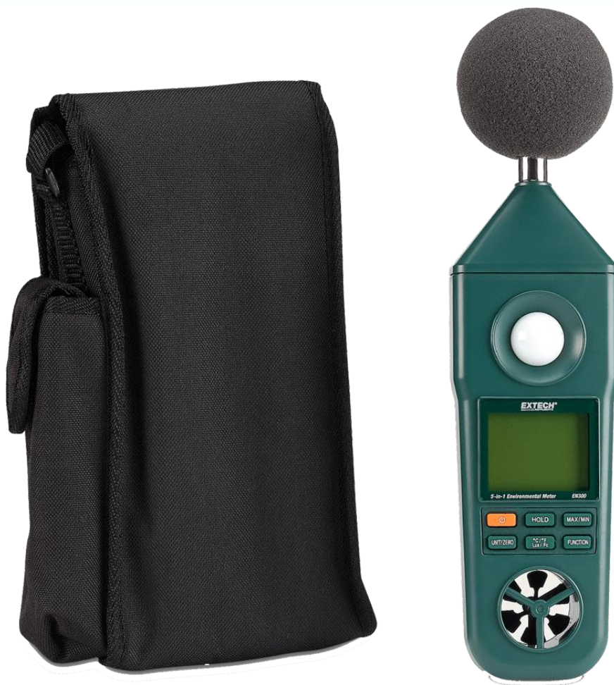
Figura nr. 6-2 Aparatul multiparametru utilizat pentru prelevare date de zgomot in timp real pe amplasamentul Kastamonu Romania
