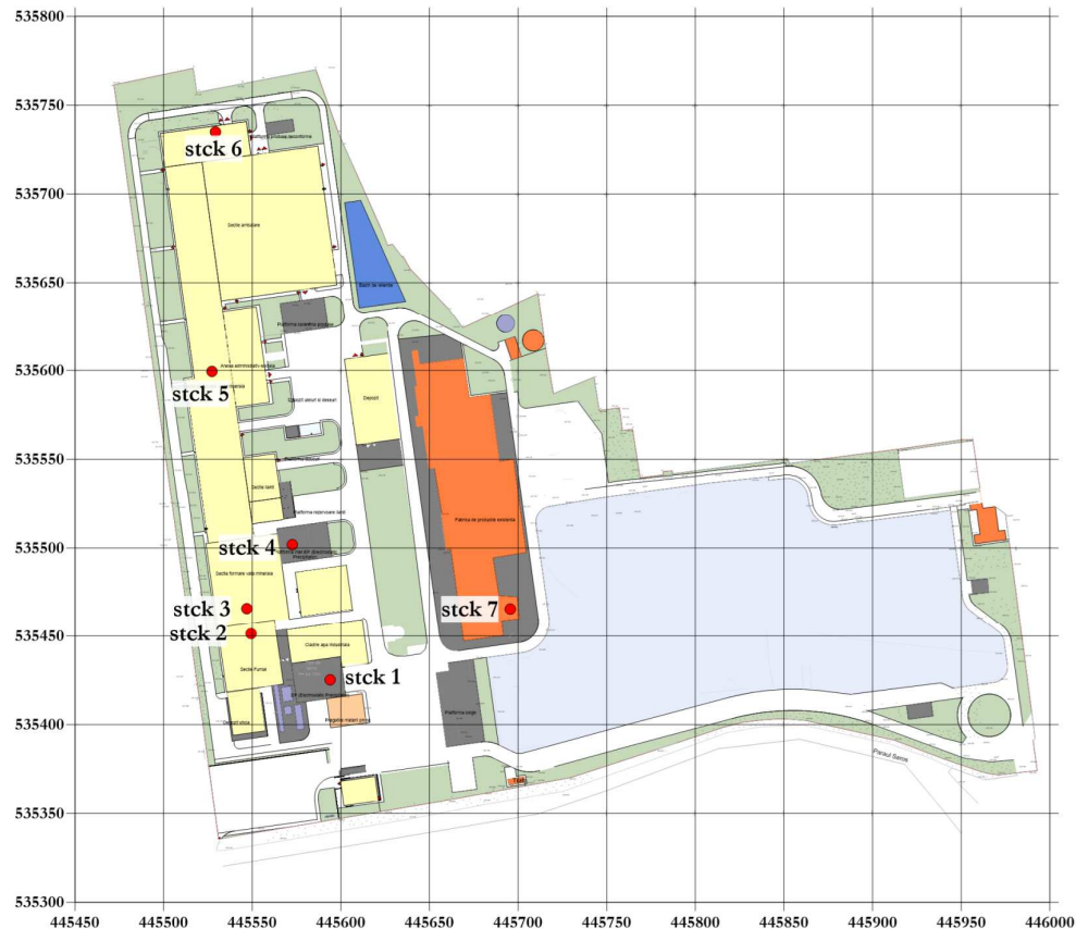
Figura 8. Amplasarea cosurilor de emisie (stack)
