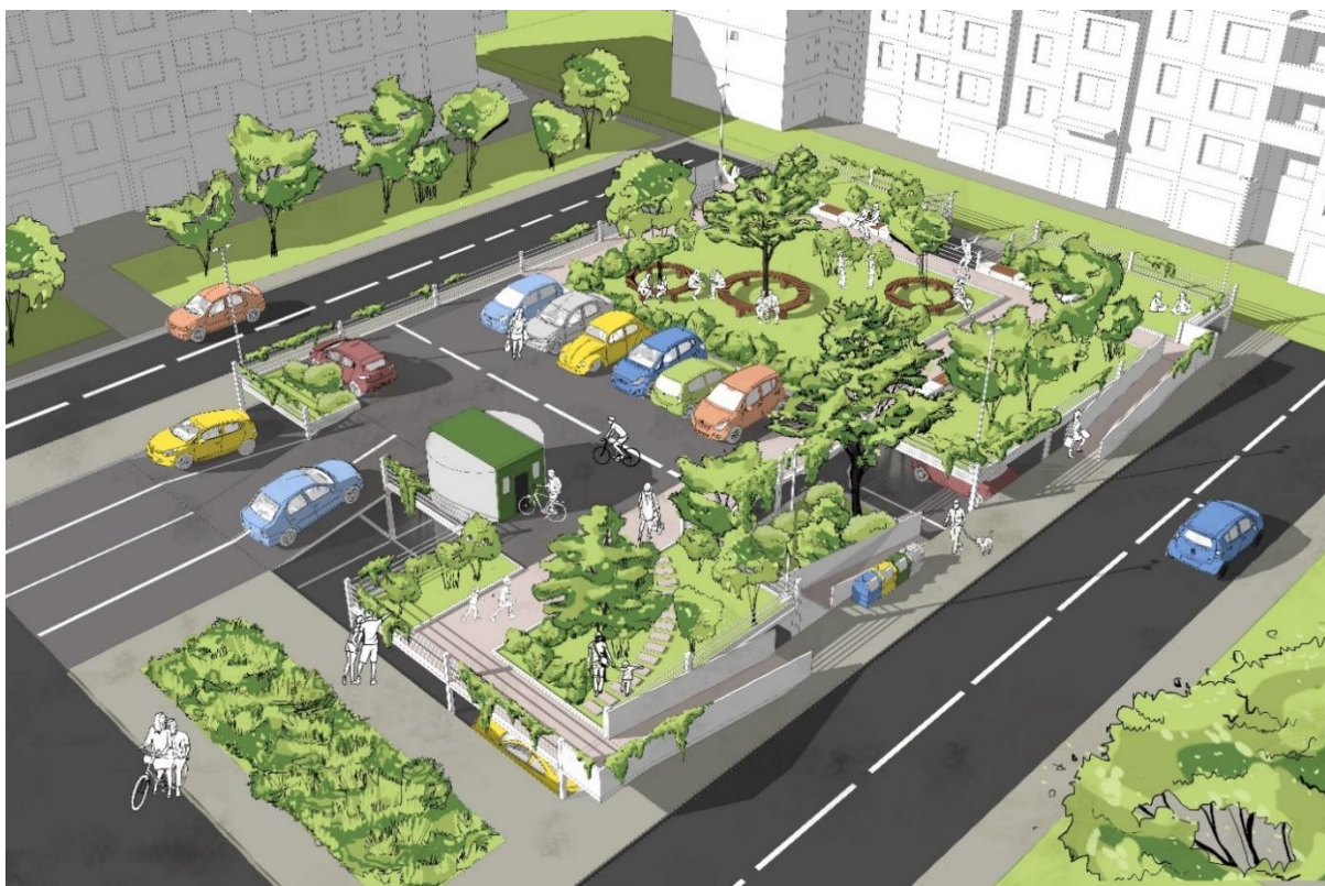
Mod de amenajare parcare 2 nivele cu nivelul superior axat pe spatiu verde si locuri de parcare
