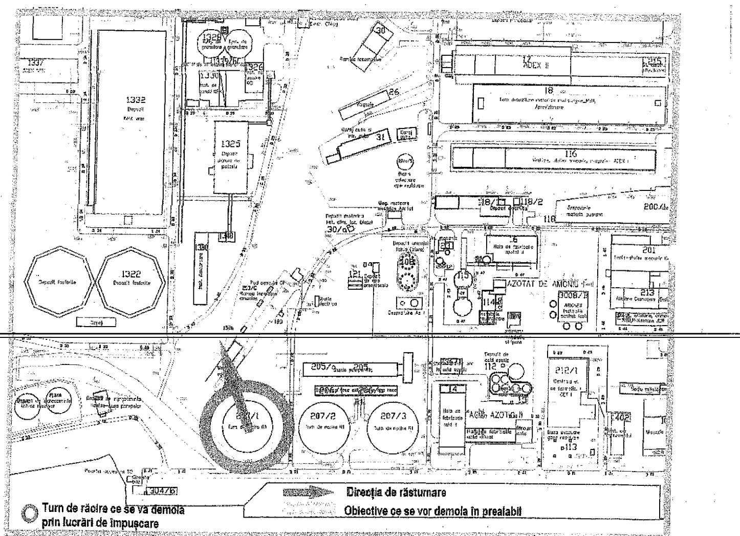
**Turnul de răcire** din incinta Azomureş S.A., care urmează a fi demolat este de forma unui hiperboloid de rotație realizat din beton armat, prin glisare cu secțiune variabilă.
